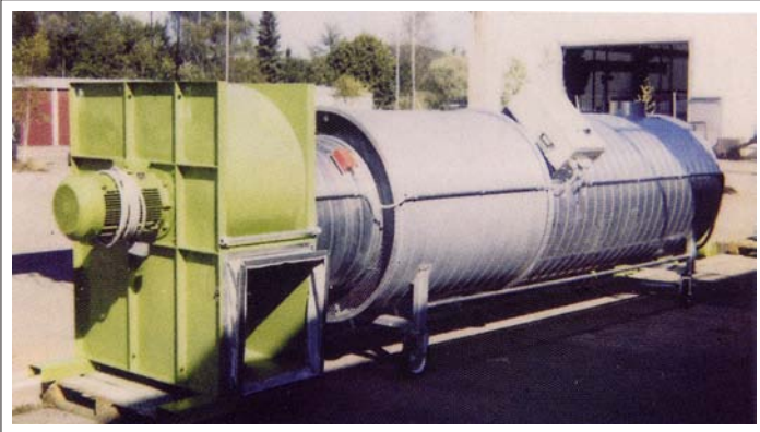
Warmluftgerät für hohe Trocknungstemperaturen (100°C), z.B. Mais-/ Kürbistrocknung, bis 700 kW Heizleistung
